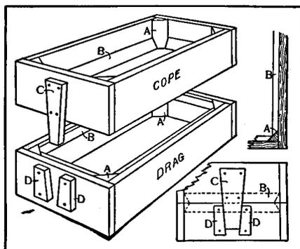
Fig. 2 - Homemade Flask
